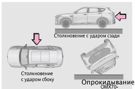
Фронтальная подушка безопасности водителя и фронтальная подушка безопасности переднего пассажира могут не сработать, если автомобиль попал в боковое или заднее столкновение, перевернулся или попал в лобовое столкновение на низкой скорости.
