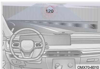
После того, как система TSR распознает информацию о знаке ограничения скорости на дороге впереди, на комбинации приборов отображается «120», если скорость превышает текущее ограничение скорости на 5 км/ч, «120» на комбинации приборов мигает 3 раза.
