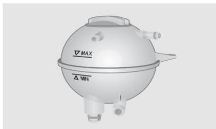
На холодном двигателе уровень охлаждающей жидкости должен находиться между отметками MIN и MAX. Если уровень охлаждающей жидкости опустился до отметки MIN или ниже ее, долейте охлаждающую жидкость в бачок и незамедлительно обратитесь на сервисную станцию официального дилера Jetour для проверки и ремонта автомобиля.
