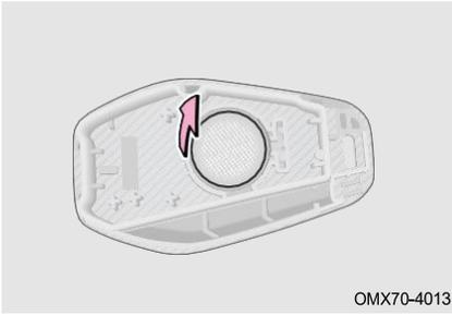
Шаг 3: Извлеките аккумулятор из смарт-ключа с помощью плоской отвертки с заклеенным кончиком и установите новый аккумулятор.
