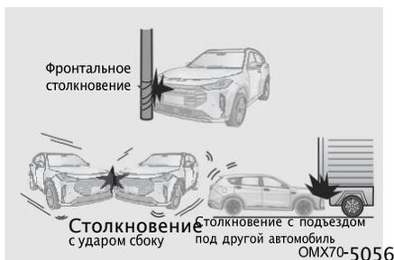
Фронтальная подушка безопасности водителя и фронтальная подушка безопасности переднего пассажира могут не сработать, если передняя часть автомобиля ударится о столб, попадет под грузовик или коснется боковым ударом сбоку.
