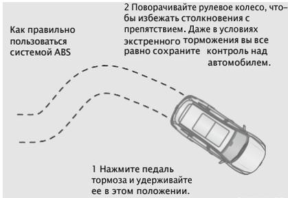
ABS не работает при обычном торможении и немедленно включается только при экстренном торможении
