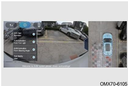
[Начальный экран панорамного просмотра] При первом включении монитора кругового обзора на дисплей выводится главный экран монитора кругового обзора.
