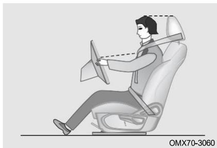
Находясь в сиденье, сидите с небольшим наклоном назад (в идеале угол наклона назад составляет  $-25^\circ$ ) и хорошо прижмитесь к спинке. Передние сиденья не должны располагаться слишком близко к панели приборов. Во время движения водитель должен держать руль слегка согнутыми руками. Ноги водителя также должны быть слегка согнуты, чтобы он мог полностью выжать педали. Правильно отрегулируйте подголовники, чтобы верхняя часть подголовника находилась ближе всего к макушке головы.
